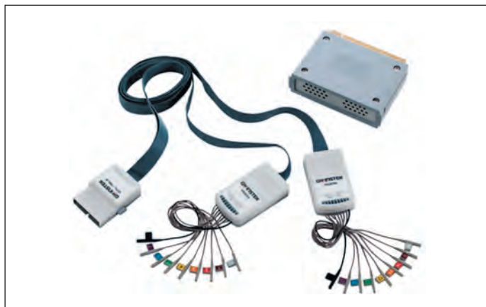
Рис. 3. Опция логического анализатора и 16-канальный пробник логических сигналов
